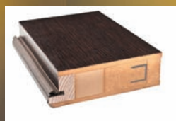
Skrzydło o grubości 46 mm z uszczelką, ramiaki drewniane wzmocnione ceownikiem stalowym gr. ścianki 2 mm, wypełnienie płyta pełna
